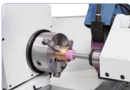
Sériově dodávaný s výklopným zařízením na vnitřní broušení
