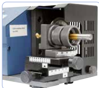
Nastavitelný vrcholový úhel od -30° do +30°
