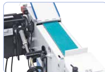
Plocha pro rovinné broušení 400 x 100 mm rozšiřuje oblast využití
