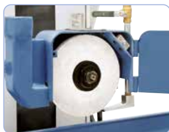
Speciální předpjatá ložiska zajišťují chod bez vibrací a vysokou přesnost brusného vřetena
