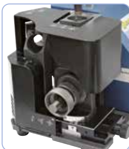
Broušení vrcholového úhlu
