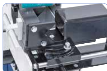
Stupnice umožňuje přesné nastavení úhlu broušení
