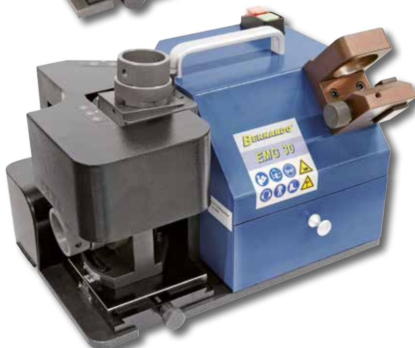
Broušení úhlu podbroušení u 2břítých fréz
