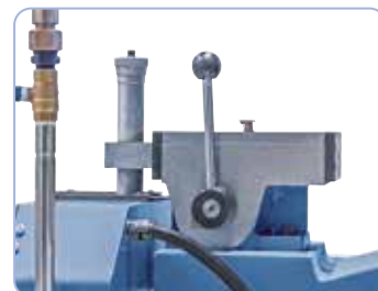
Součástí dodávky je paralelní orovnávací přípravek
