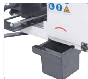
Jednoduše odnímatelná přípojka pro odsávání třísek
