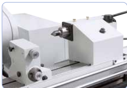
Pedálem ovládaný pojezd hydraulického koníku s vysokou přesností a stabilitou
