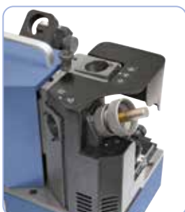
Broušení úhlu podbroušení u 2břítých fréz
