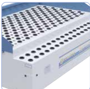
Snadné broušení hran s odsazenou plochou stolu.
