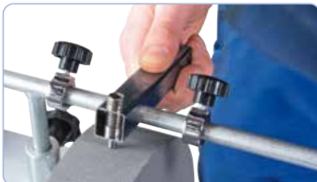
Diamantový orovnávač kotoučů 05-2058: ke kruhovému a přímému orovnávání brusného kotouče
