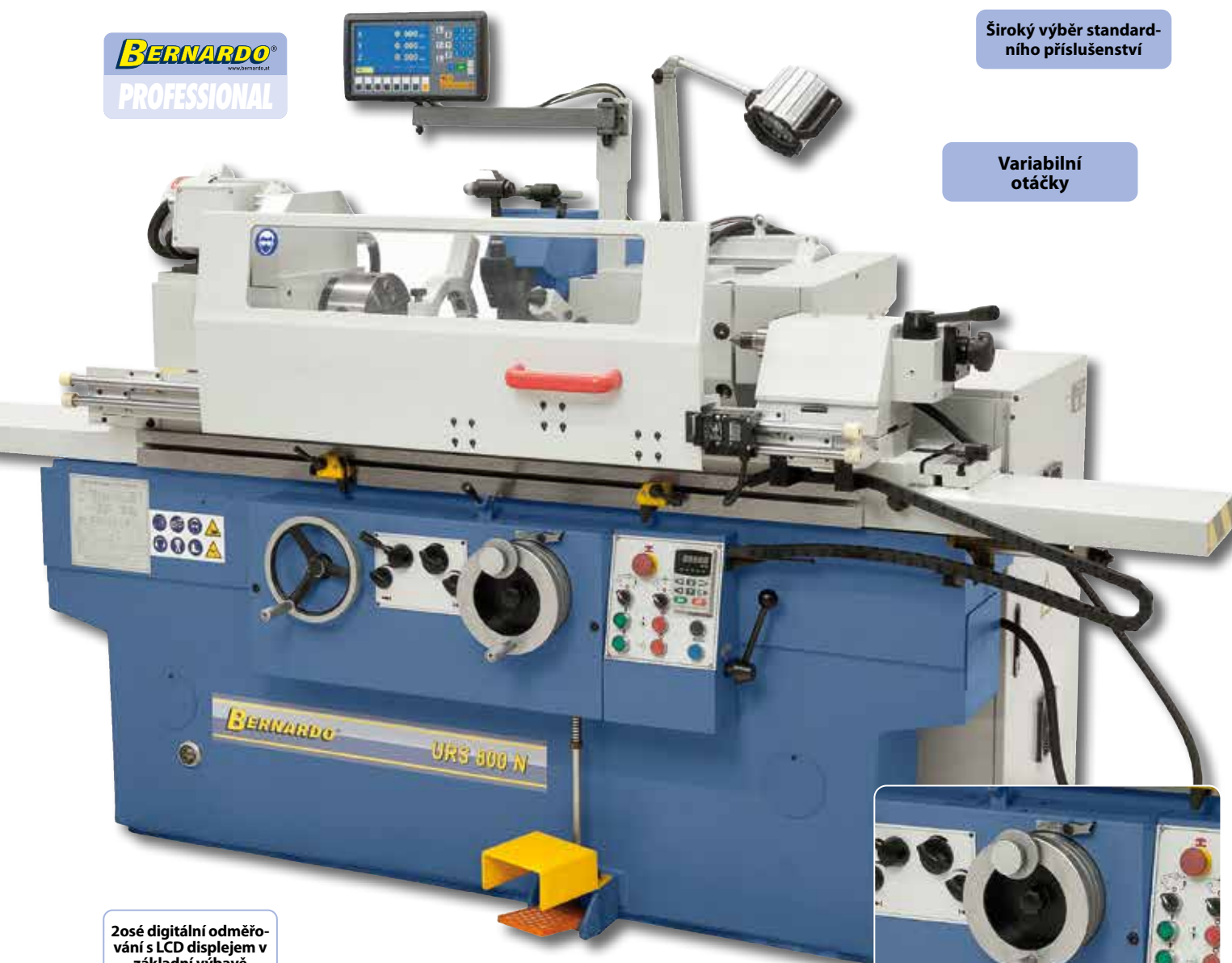
Naklápěcí hlava vřetena je při broušení kuželů nastavitelná v úhlu 0° - 90°
