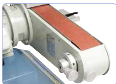
Velká plocha pro rovinné broušení, nastavitelná opěrka obrobku
