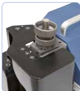
Broušení řezné hrany 1 a 3
