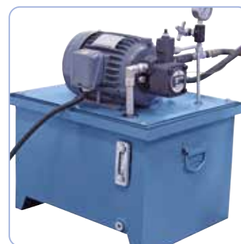
Samostatná hydraulická jednotka eliminuje vibrace a tepelné namáhání
