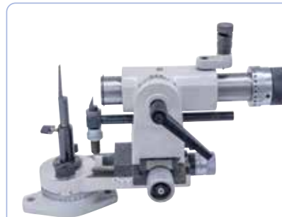
Zařízení na broušení rádiusových a čelních fréz 50E, Rozsah broušení: 6 - 25 mm (na objednávku).
