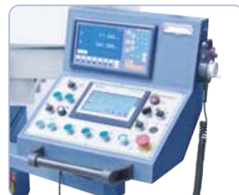
Siemens SMART-panel IE V3 s dotykovou obrazovkou a elektronické ruční kolo
