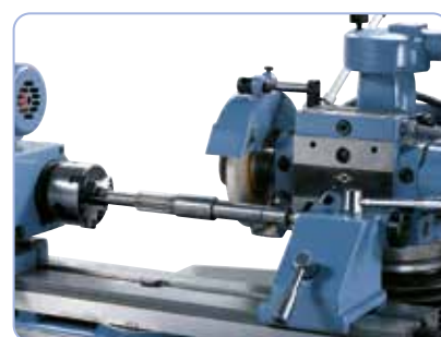
Vnější broušení válcových ploch
