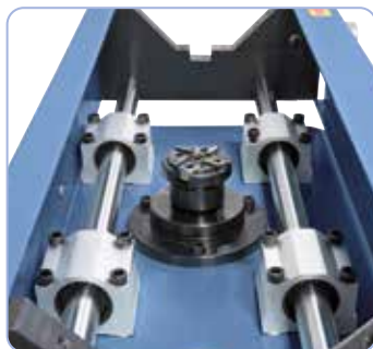
Odolné vedení válcovými sloupky pro rovnoměrný pojezd vodící lišty
