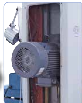
Robustní vedení brousící hlavy zajišťuje přesné přístavení.
