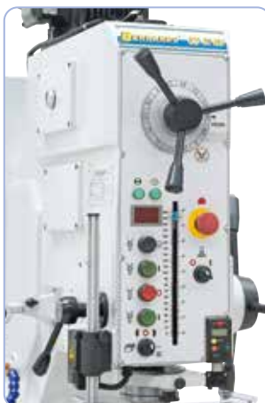
Pohodlné motorické nastavení výšky stolu
