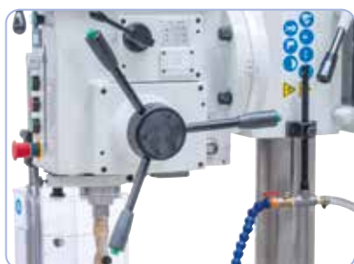
Sériově vybavená automatickým 3 stupňovým posuvem vřetena
