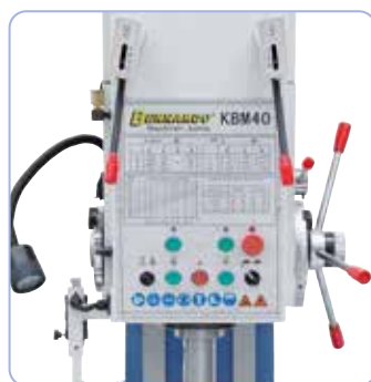
Vrtací hlava má přehledně uspořádané veškeré ovládací a obslužné prvky.
