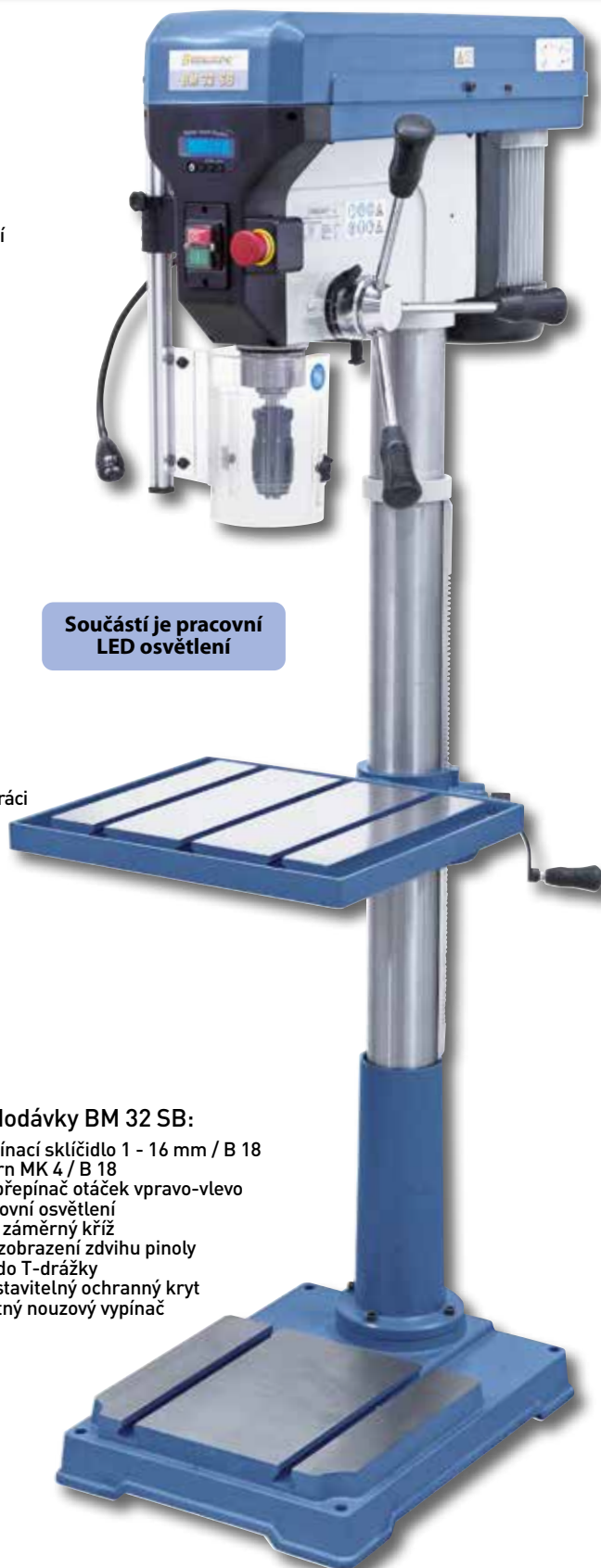
Digitální zobrazení hloubky vrtání zjednodušuje obsluhu
