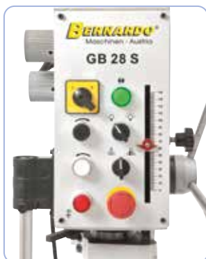
Přehledně uspořádané ovládací prvky. Sériově dodávána se zařízením pro řezání závitů
