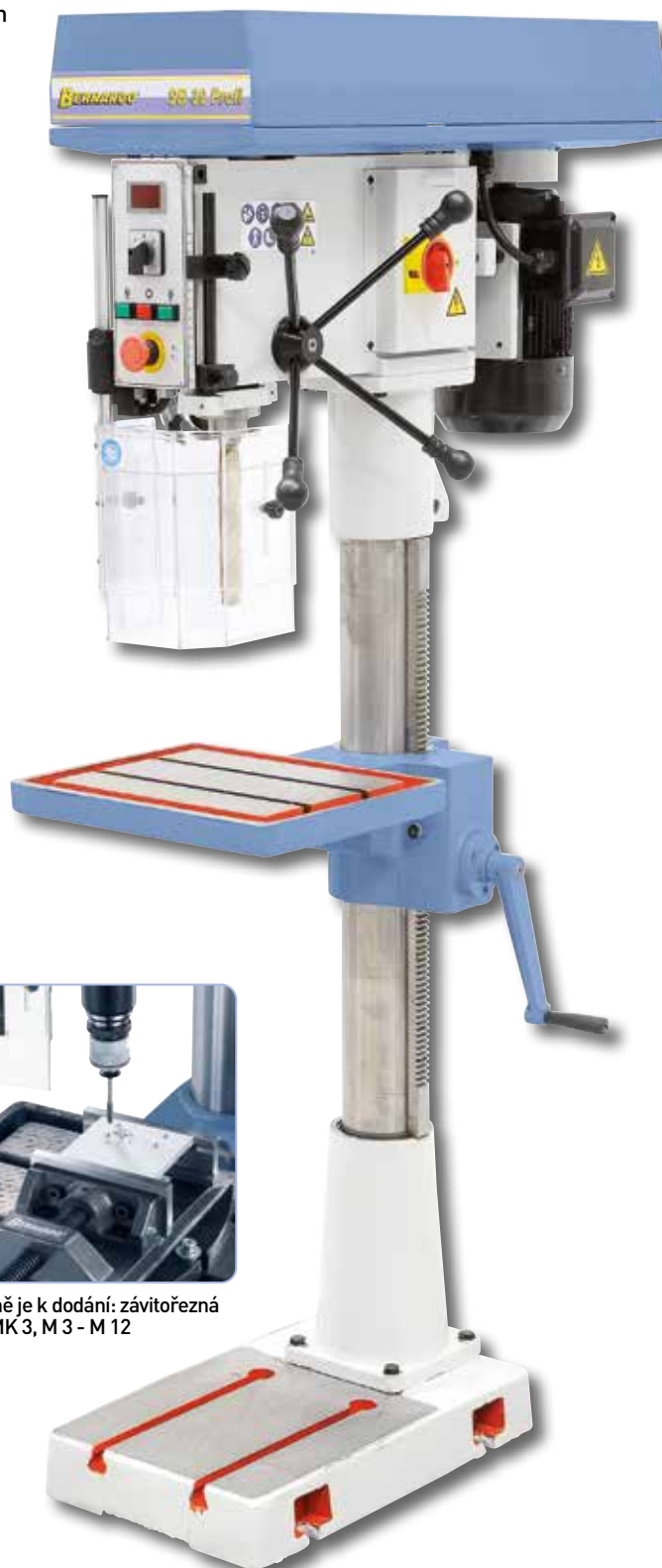
Sériově vybavená digitálním zobrazováním otáček. Ergonomicky umístěné ovládací a obslužné prvky na přední straně
