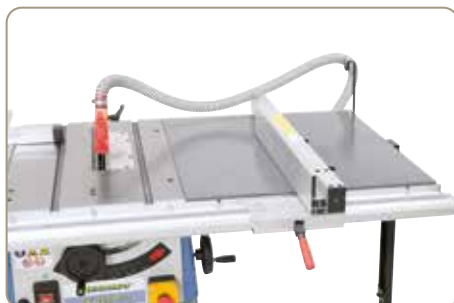
Volitelné rozšíření stolu umožňuje šířky řezu až 725 mm
