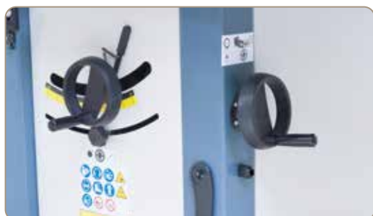
Nastavení pilového agregátu se provádí ergonomicky umístěným ručním kolem na tělese stroje
