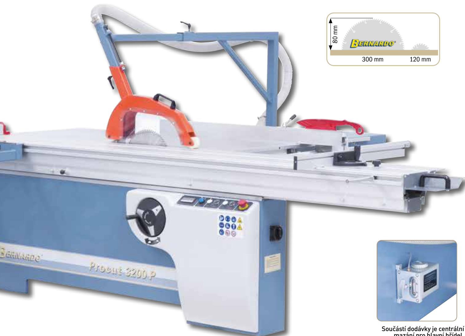
Sériově dodávána s agregátem předřezu zajišťujícím opracování deskových materiálů bez otřepů
