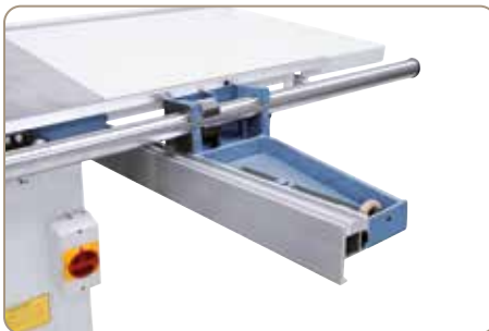
Sklopné paralelní pravítko s mikrometrickým jemným nastavováním (je výhodou u velkých desek)
