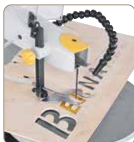
Výškově nastavitelný průhledný kryt pilového listu umožňuje volný výhled na obrobek
