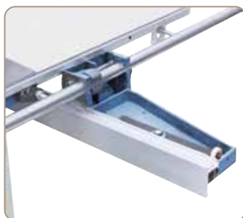
Paralelní pravítko se při řezání velkých dílů jednoduše odklopí.
