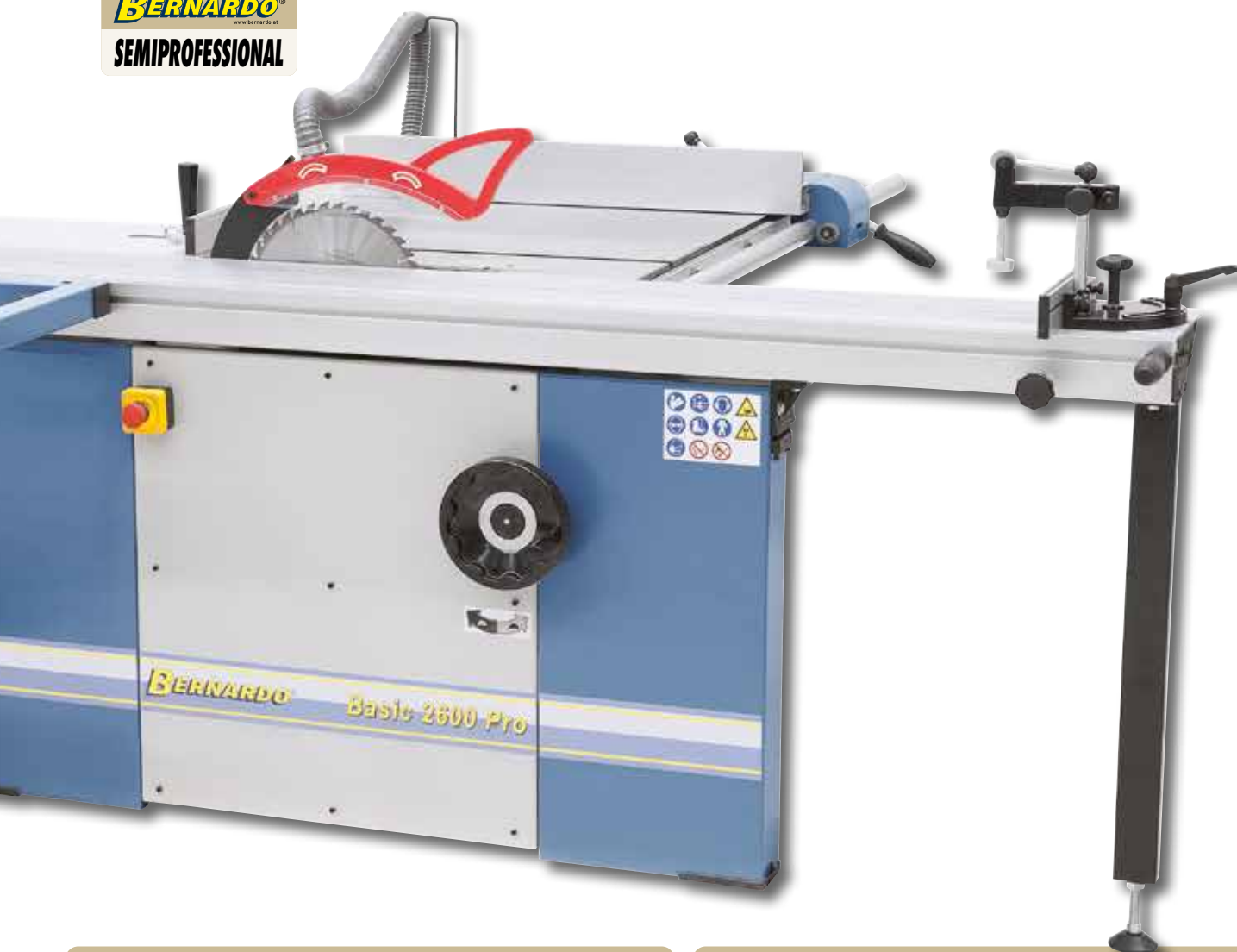
Paralelní doraz se stabilním vedením z kruhových tyčí (40 mm) lze použít pro šířky řezu do 1200 mm
