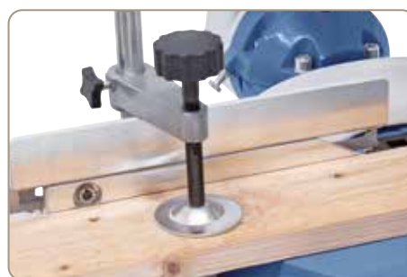
Bezpečná fixace obrobku výškově nastavitelným upínacem.
