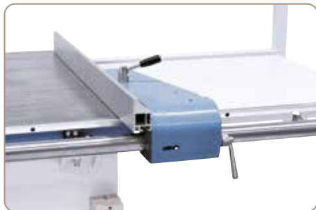
Paralelní doraz se stabilním vedením z kruhových tyčí lze použít pro šířky řezu do 1300 mm
