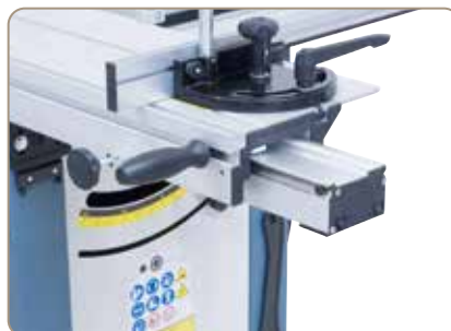
Dostatečně dimenzovaný formátovací stůl s lehkým chodem na kaleném prismatickém vedení
