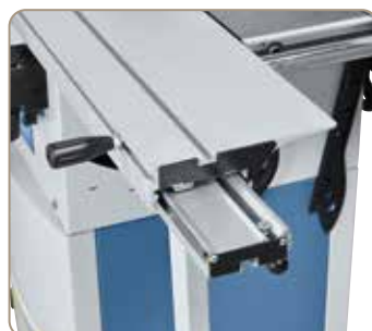
Kalené prizmatické vedení zajišťuje lehký chod formátovacího stolu
