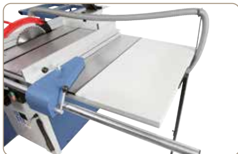
Paralelní doraz se stabilním vedením z kruhových tyčí (40 mm) lze použít pro šířky řezu do 1200 mm
