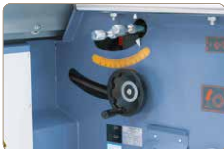
Uživatelsky komfortní výškové a boční nastavení agregátu předřezu
