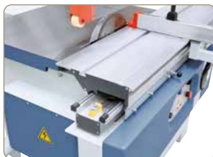
Dostatečně dimenzovaný formátovací stůl s lehkým chodem se na kaleném prizmatickém vedení naprosto neopotřebovává
