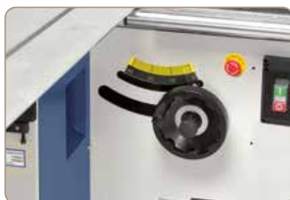
Rychlé a jednoduché nastavení výšky pilového kotouče pomocí ergonomicky umístěného ručního kola
