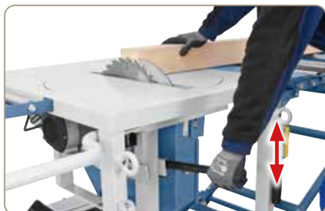
Přímý kapovací řez 90°.
