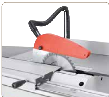
Kryt pilového kotouče s integrovaným hrdlem pro odsávání, je upevněn na rozevřacím klínu
