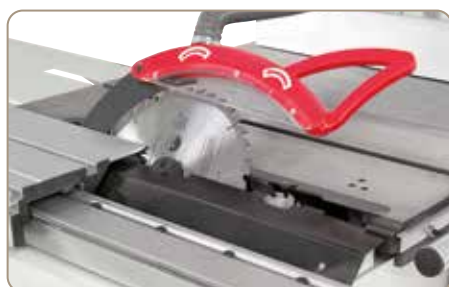
Kryt pilového kotouče s integrovaným hrdlem pro odsávání, je upevněn na rozevřacím klínu. Sériově vybaveno agregátem předřezu.
