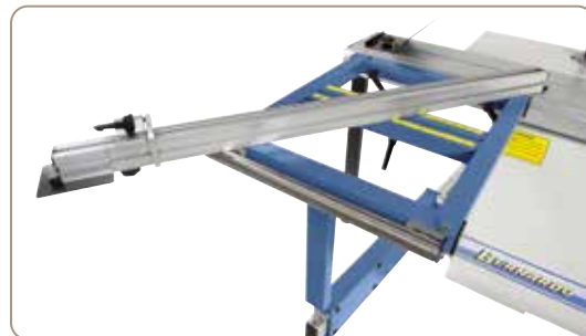
Na výložníkový stůl lze namontovat vpředu a vzadu plynule sklopný (2 x 45°) teleskopický doraz.
