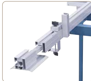
Výsuvné teleskopické pravítko, lze namontovat na přední nebo zadní část pracovního stolu
