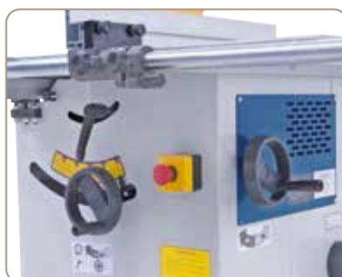
Výškové nastavení, popřípadě naklápění pilového agregátu se provádí ergonomicky umístěným ručním kolem
