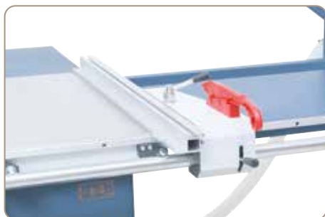
Paralelní doraz se stabilním vedením z kruhových tyčí lze použít pro šířky řezu do 1350 mm
