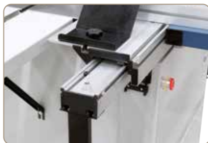
Dostatečně dimenzovaný formátovací stůl s lehkým chodem se na kaleném prismatickém vedení naprosto neopotřebává
