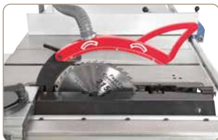
Sériově dodávaná s agregátem předřezu zajišťujícím opracování deskových materiálů bez otřepů
