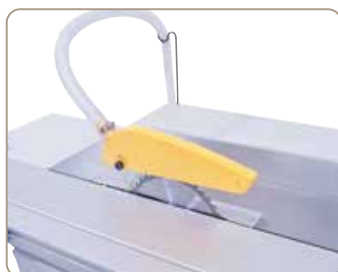
Kryt pilového kotouče s integrovaným hrdlem pro odsávání, je upevněn na rozevíracím klínu
