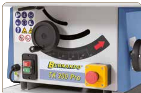
Spínač ZAP-VYP třídy krytí IP54 s podpětovou spouští a samostatný spínač nouzového zastavení
