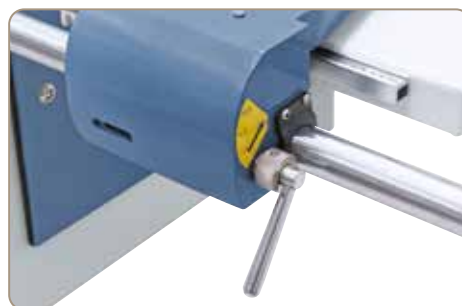
Paralelní mikrometrické pravítko vybavené jemným nastavováním lze použít na šířky řezu do 1295 mm
