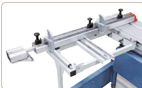
Masivní výložníkový stůl lze posouvat po celé délce suportu a lze jej odebrat v každé poloze. Vysouvací teleskopický doraz s 2 masivními sklopnými zarážkami je nastavitelný s milimetrovou přesností.
