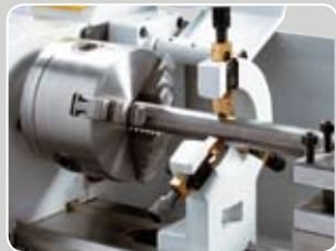
Feststehende Lünette mit Bronzeführung zum Stabilisieren von langen Werkstücken.
