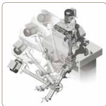
Ideal auf Tischfräsen zum einfachen Abklappen des Vorschubes (Option)
